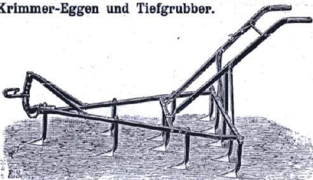
144. Krimmer-Egge mit Handhaben, stellbarem Zughaben und 12 Gänsefuß- oder Grubber-(Löffel-)Scharen. Arbeitsbreite 1,20 m. Gewicht 50 kg. Preis M. 37.— Eine desgleichen in leichterer Ausführung, mit kürzeren Zinken. Gewicht 43 kg. Preis M. 33.—
