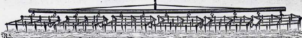
137. Marke VIS. Leichte Feinegge mit nach vorn gerichteten spitzen Rundzinken, in 4-6 Feldern mit je 3 Längs- und 4 Querbalken aus Flachstahl und 20 Zinken. Für 1-2 Pferde. Gewicht des Satzes von 6 Feldern 81 kg, Arbeitsbreite 4 m. Preis M. 65.—
